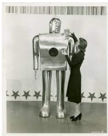
Фиг 1.2. Хуманоиден робот Elektro: 2.1м височина и тежест 120кг.
