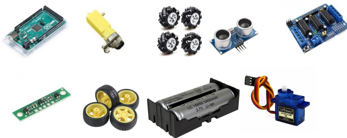
Фиг 2.19. Компоненти за изграждане на мобилен робот с диференциално задвижване на колелата и робот с Месанит колела.
