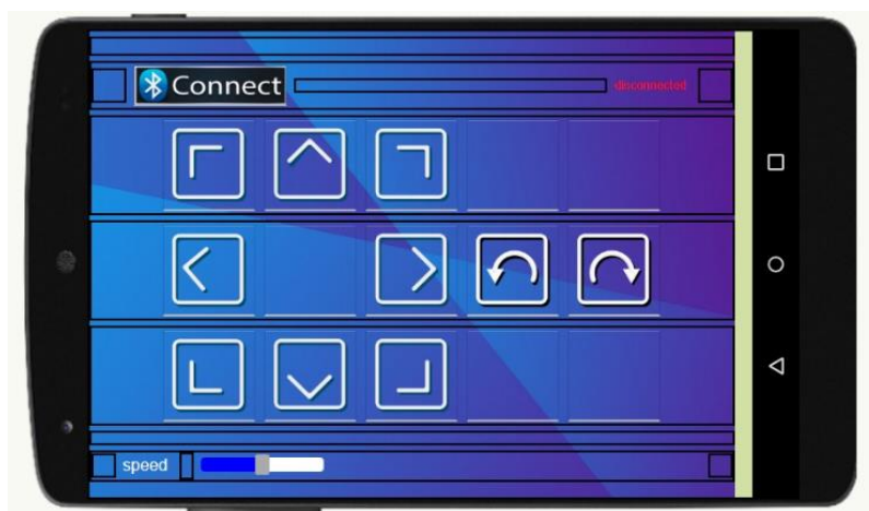
Фиг 3.8. Интерфейс за телеуправление на транспортен робот посредством смартфон или таблет
