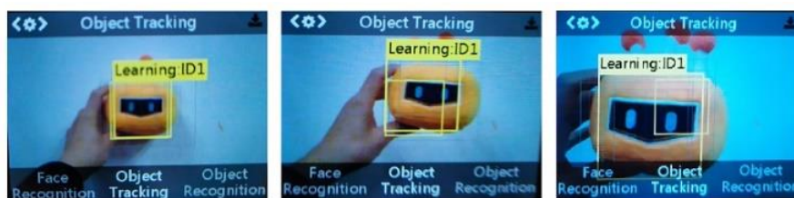
Фиг 2.31. Настройки на HuskyLens в режим Object Tracking..
