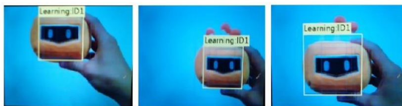
Фиг 2.32. Готова настройка и тест на HuskyLens в режим Object Tracking..
