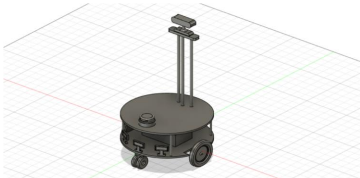
Фигура 63. Мобилна робот-платформа с монтиран модул за наблюдение и охрана
