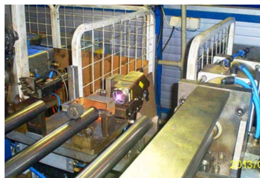
Фиг. 1.9 Машина за лазерно заваряване на щанцован детайл с болт към тръба
