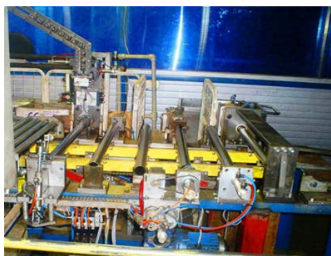
Фиг. 1.9 Машина за лазерно заваряване на щанцован детайл с болт към тръба
