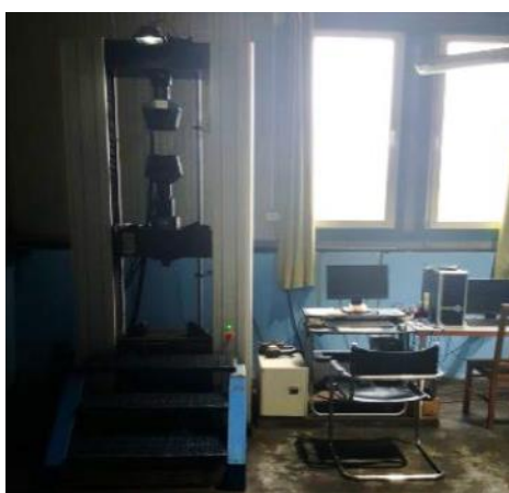
Фиг. 4.1. Универсална машина за якост на опън WDW-300
