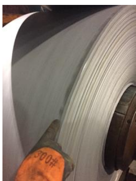
Фиг. 2.13 Байцван горещо валцуван рулон с недотрав (окис по повърхността на рулона)
