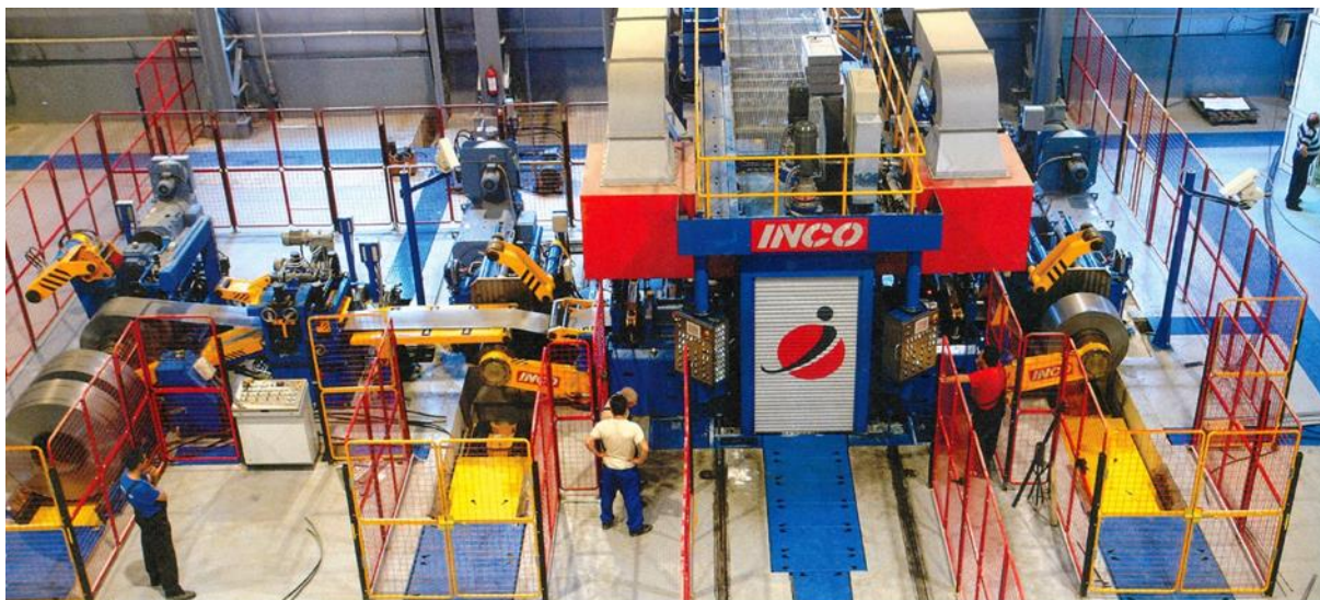
Фиг. 2.6. Едноклетков реверсивен стан за студено валцуване INCO
