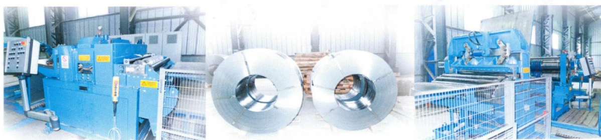
Фиг. 2.3. Агрегат за надлъжно и напречно рязане АНР/Р
