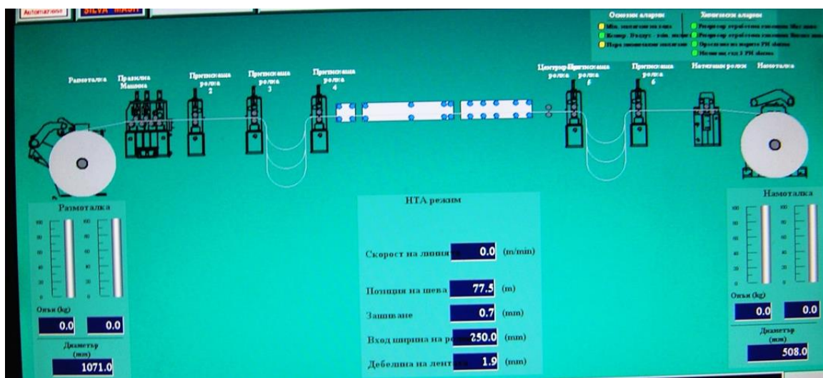
Фиг. 2.4. Схема за движение на лентата чрез теглещи ролки
