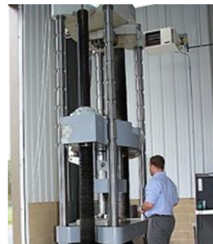
Фиг. 1.19. Универсална машина за изпитване на якост на опън
