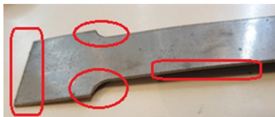
Фиг. 4.15. Пробно тяло с усенъци (преди заточване на пресата)
