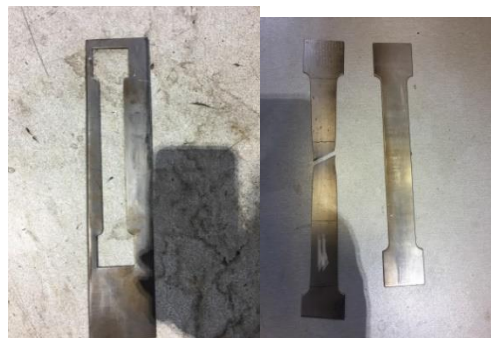
Фиг. 4.3. Заготовка за пробно тяло, епруветка преди и след тестване
