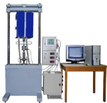
Фиг. 1.21. Стенд за изпитване при висока температура
