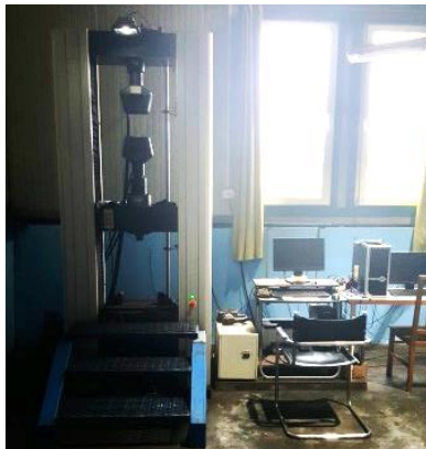
Фиг. 1.16. Универсална машина за якост на опън WDW-300
