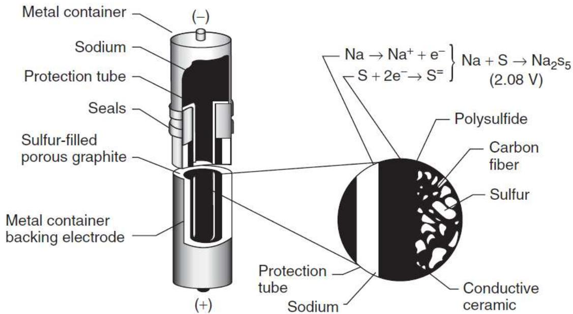
Фигура 2.6 High-temperature sodium–sulfur battery
