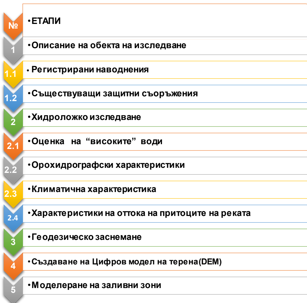
Фигура 2.2. Етапи на емпиричен модел с изграждане на дигитален модел на терена за речното корито и заобикаляща геометрия на зоната
