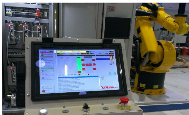
Фиг. 11 Операторски пулт за управление на реинженирания робот KUKA KR-150
