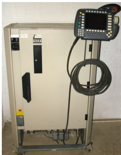
Фиг. 6 Табло за управление на KUKA KR 150 Фиг. 7 Панел за ръчно управление на KUKA KR 150
