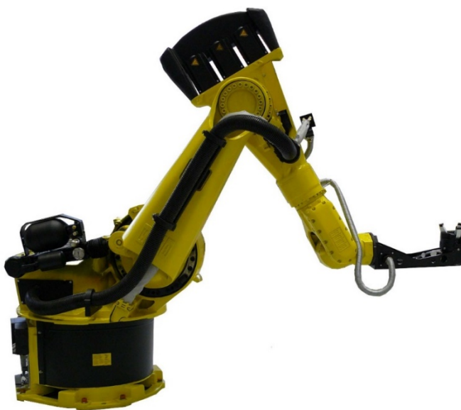
Фиг. 13 Функционално действащ лабораторен модел на реинженирания типопредставител на ИУР – KUKA KR-150 , с монтиран към него трипръстов хващач
