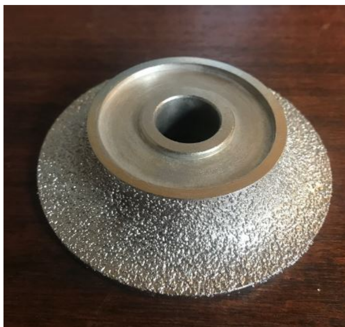
Фиг.4.4 Диамантен инструмент за обработка на гранит (образец 1)
