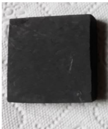
Фиг.4.27 Борен карбид спечен при 2200 градуса, липсва спичане
