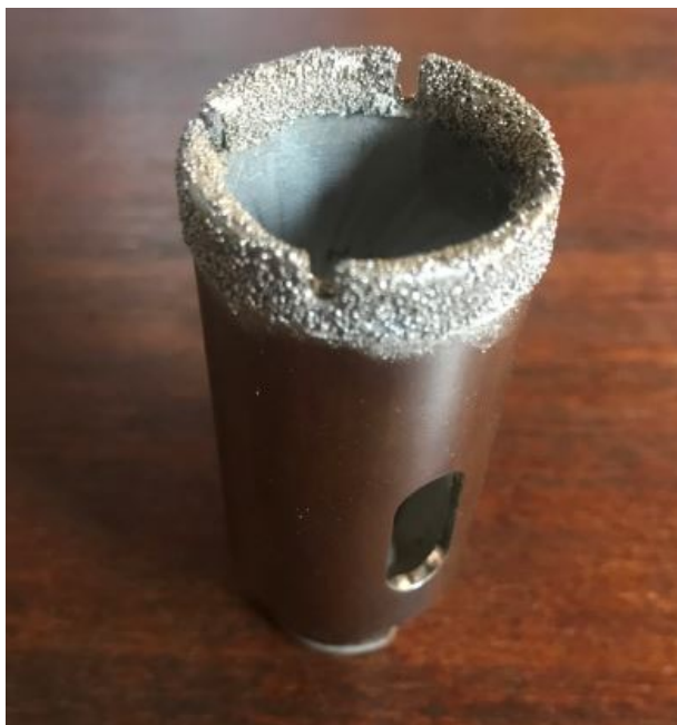
Фиг.4.5 Диамантен инструмент за пробиване (образец 2)
