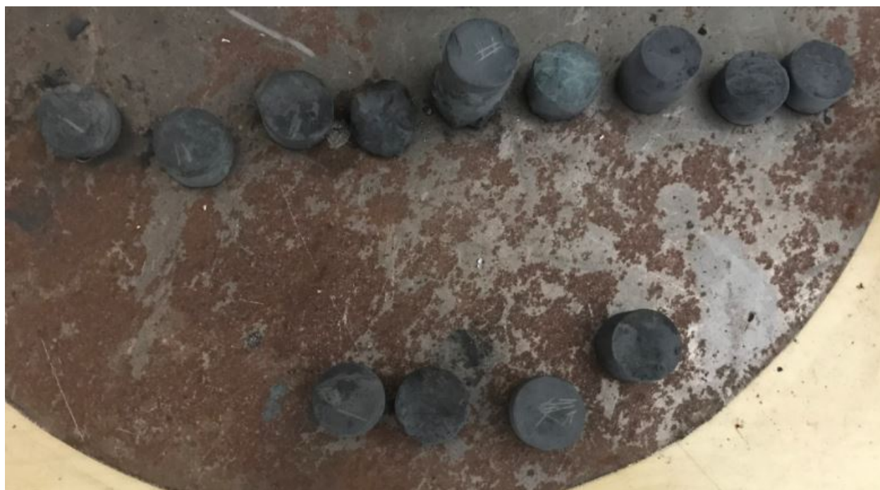
Фиг.4.23 Спичане на 2% Si към SiC , 4% Si към SiC, 6% Si към SiC , 10% Si към SiC , %2Si+C , %4Si+C , %6Si+C , 1%B 4 C към SiC, 3%B 4 C към SiC , 5%B 4 C към SiC , 10% B 4 C към SiC , 2% 2H 3 BO 3 , Al 2 O 3 8% при температури 1800-1850°C
