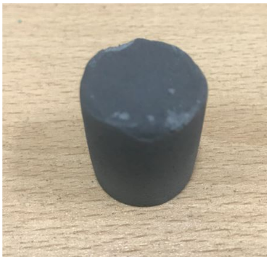
Фиг.4.19 спичане на 6\% \text{Si} + \text{C} при 1650^\circ\text{C}
