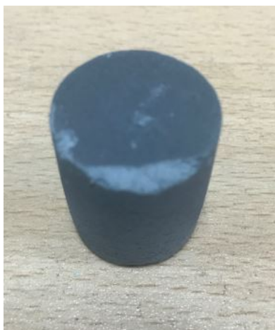
Фиг.4.14 спичане на 2% Si към SiC при 1650°C
