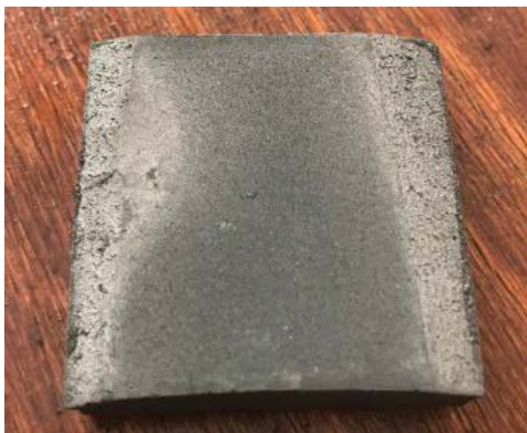
Фиг.4.30 Борен карбид спечен при 2260 градуса, изделието е спечено само по краищата.
