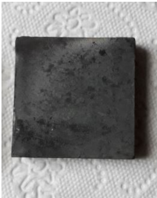
Фиг.4.28 Борен карбид спечен при 2220 градуса,сивите места на плочката показват започване образуване на течна фаза
