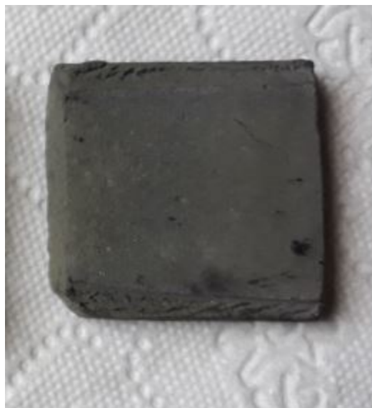
Фиг.4.29 Борен карбид спечен при 2240 градуса, изделието е задържано 15 минути в горещата зона.
