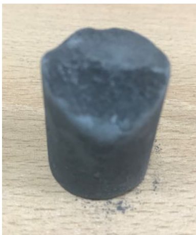
Фиг.4.12 спичане на 6%Si+ C при 1440 градуса.
