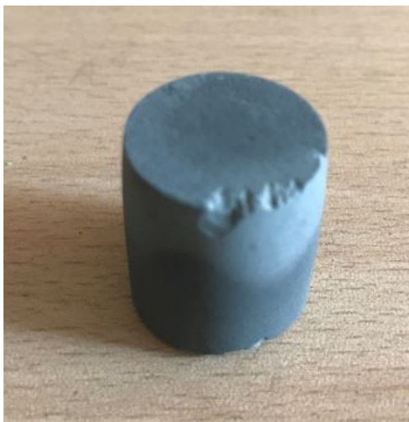
Фиг.4.20 спичане на 3\% \text{B}_4\text{C} при 1650^\circ\text{C}
