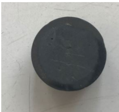
Фиг.4.24 Спечен образец в таманова пещ с добавка B_4C към SiC , изделието е с 71% плътност
