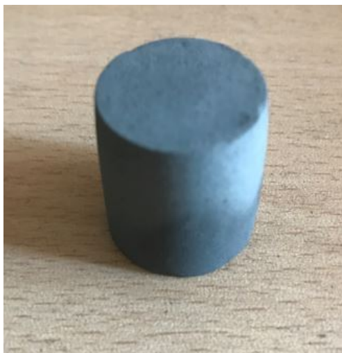
Фиг.4.21 спичане на 5% B_4C при 1650^{\circ}C
