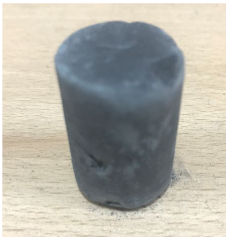
Фиг.4.10 спичане на 6% Si към SiC при 1440 градуса.
