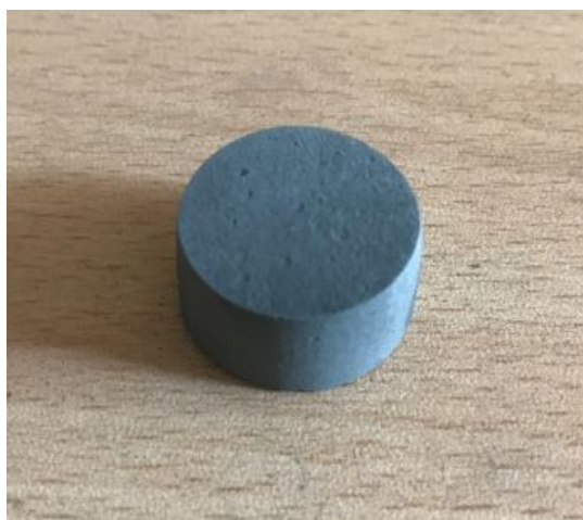
Фиг.4.22 спичане на 10% B_4C при 1650^{\circ}C
