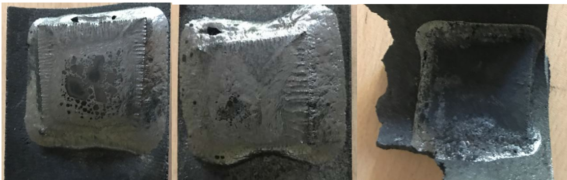
Фиг.4.31 Борен карбид спечен при 2280 градуса,изделието е протекло, но ясно се вижда образуването и нарастването кристалите вследствие на течната фаза.
