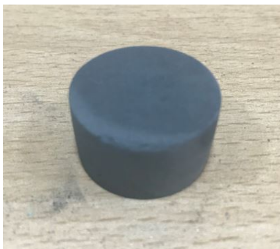
Фиг.4.11 спичане на 2%Si+ C при 1440 градуса.
