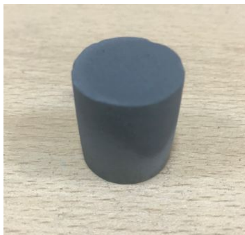
Фиг.4.15 спичане на 4% Si към SiC при 1650°C
