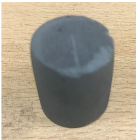
Фиг.4.9 спичане на 4% Si към SiC при 1440^{\circ}\text{C} .
