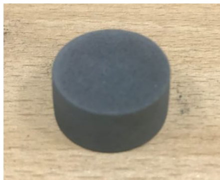
Фиг.4.13 спичане на 2% 2\text{H}_3\text{BO}_3 C при 1440 градуса.
