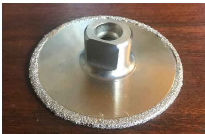
Фиг.4.5 Диамантен инструмент за пробиване (образец 2)
