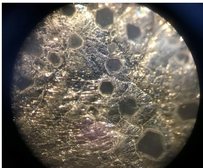
Фиг.4.31 Борен карбид спечен при 2280 градуса,изделието е протекло, но ясно се вижда образуването и нарастването кристалите вследствие на течната фаза.
