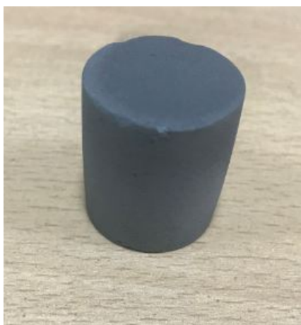
Фиг.4.18 спичане на %4Si+C при 1650°C
