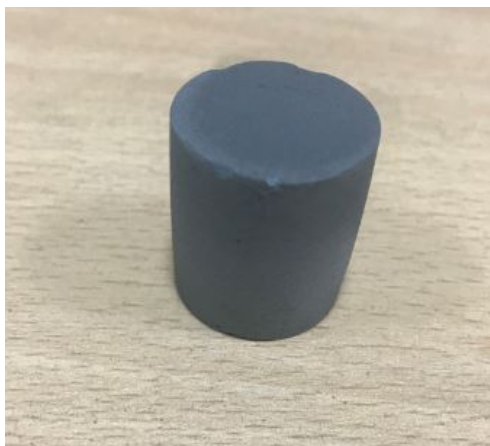
Фиг.4.16 спичане на 6% Si към SiC при 1650°C
