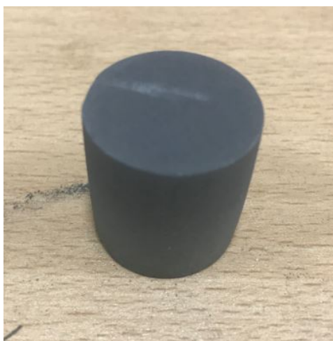
Фиг.4.8 спичане на 2% Si към SiC при 1440^{\circ}\text{C} .
