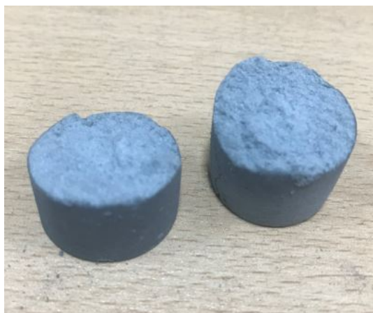
Фиг.4.17 спичане на %2Si+C при 1650°C
