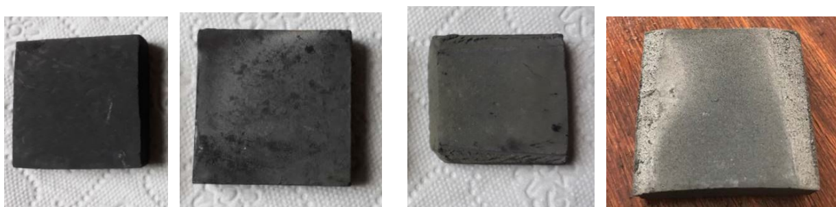
Фиг.4.18 Борен карбид спечен при 2200 градуса, липсва спичане
