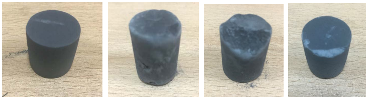
Фиг.4.6 спичане на 2% Si към SiC при 1440 градуса.
