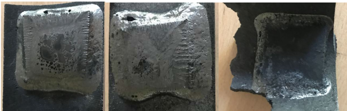
Фиг.4.22 Борен карбид спечен при 2280 градуса,изделието е протекло, но ясно се вижда образуването и нарастването кристалите вследствие на течната фаза.
