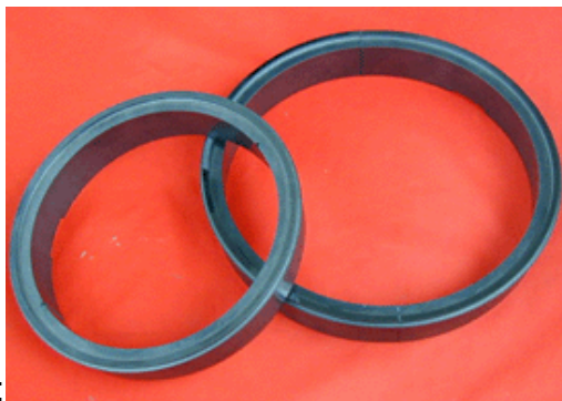
Фиг.3.2 Реакционно синтерован SiC
