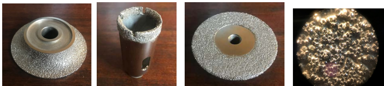
Фиг.4.2 Диамантен инструмент за обработка на гранит (образец 1)
