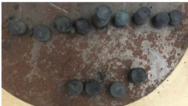
Фиг.4.14 Спичане на 2% Si към SiC , 4% Si към SiC, 6% Si към SiC , 10% Si към SiC , %2Si+C , %4Si+C , %6Si+C , 1%B 4 C към SiC, 3%B 4 C към SiC , 5%B 4 C към SiC , 10% B 4 C към SiC , 2% 2H 3 BO 3 , Al 2 O 3 8% при температури 1800-1850°C
