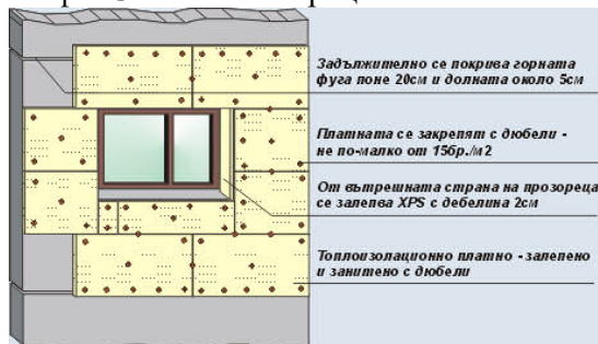
Фиг. 31: Монтаж на изолационни платна
