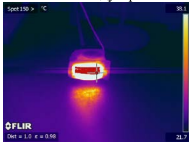
Фиг.64: Снимка с термокамера на работеща конвекторна печка
