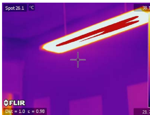
Фиг. 61: Лъчисто отопление в офис Фиг. 62: Термоснимка на работещ лъчист отоплител
