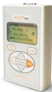
Фиг. 22: Анализатор на термична дифузия KD2 PRO Фиг. 23: Термокамера FLIR E5
