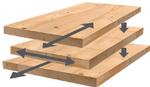
Фиг. 55: Принцип на сглобяване на CLT панел
