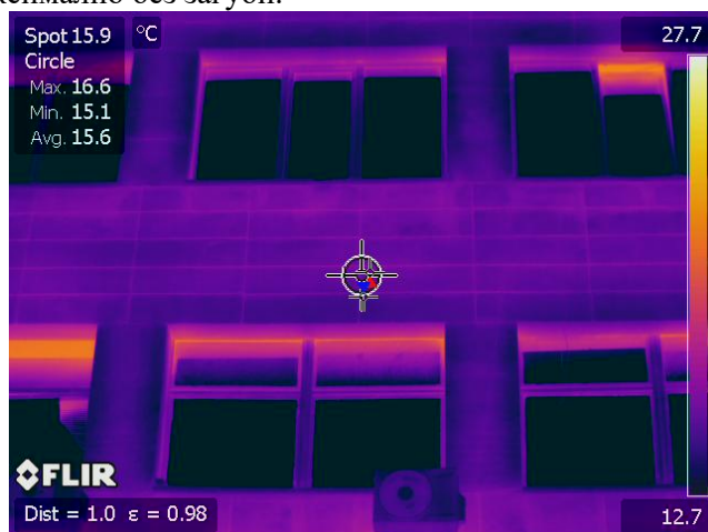
Фиг.60: Термомост при прозорец
