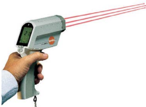
Фиг. 21: Инфрачервен термометър Testo 860-T2
