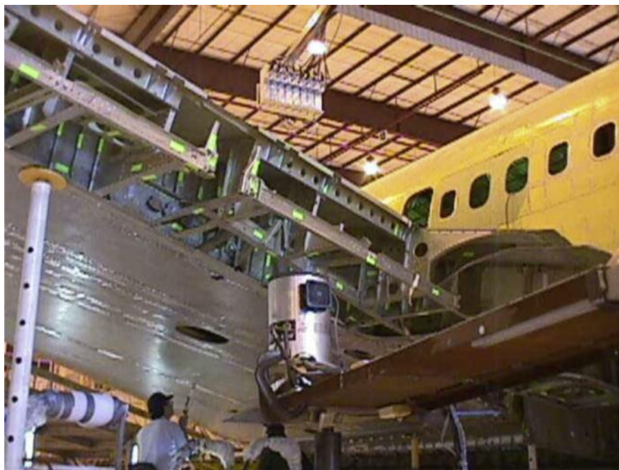
Фиг. 10: Система за ламинаграфия, която инспектира крило на самолет (Digiray Corporation)
