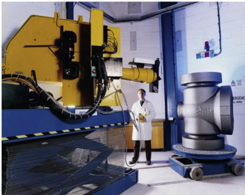
Фиг. 9: 7.000 кг стоманена отливка (тяло на клапана), подложена на рентгенография с помощта на 8.5 MeV линеен ускорител (Goodwill Steel Casting Foundry)
