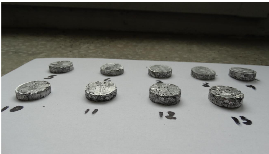
Фиг. 43: Брикети от чугунени стружки с маса 3.5 gr
