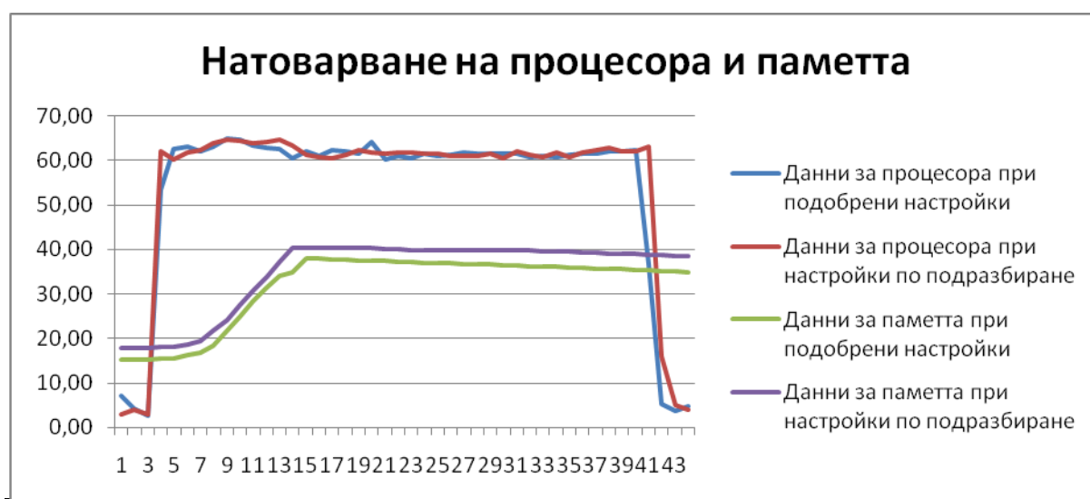
Фиг. III.12. Натоварване на процесора и паметта при различни настройки на конфигурационния файл
