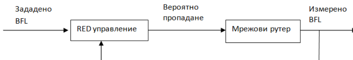
Фиг.1.3. Управление с обратна връзка в мрежови рутер [HoMTG-01a]
