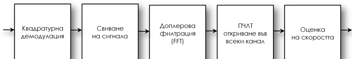
Фигура 4.12 Структурна схема на Доплеров откривател/оценител
