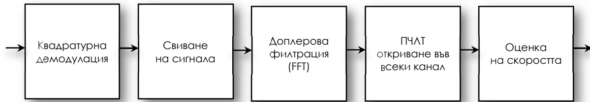
Фигура 4.12 Структурна схема на Доплеров откривател/оценител
