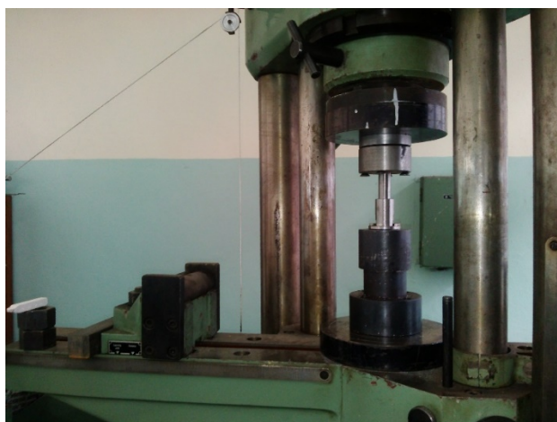
Фигура 83. Снимка на експериментална установка за деформиране чрез обратно изтичане на брикети от Al – сплав на хидравлична преса
