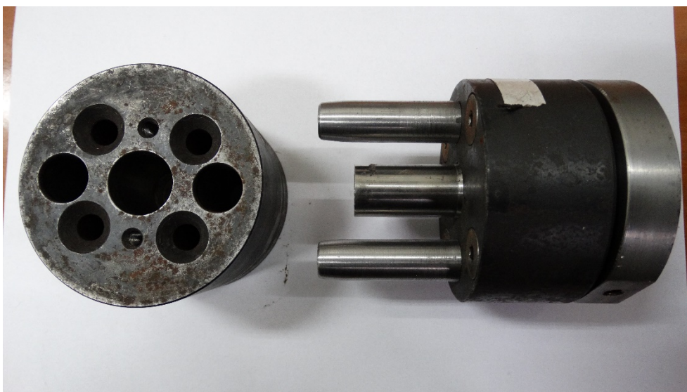
Фигура 70. Инструментална екипировка за брикетиране на метални стружки
