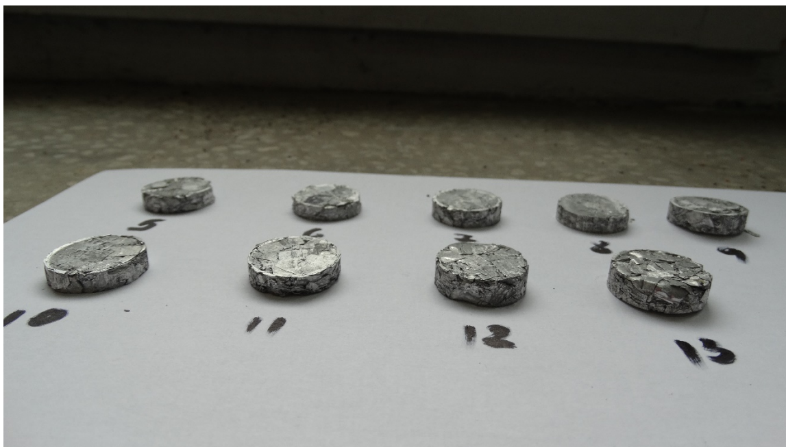
Фигура 26. Брикети от чугунени стружки с маса 3.5 gr
