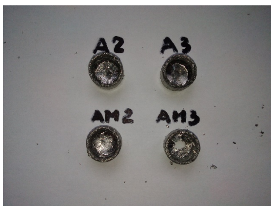
Фигура 84. Общ вид на детайли получени на хидравлична преса, чрез деформиране с обратно изтичане на брикети от Al – сплав: а – поглед от горе; б – поглед от страни
