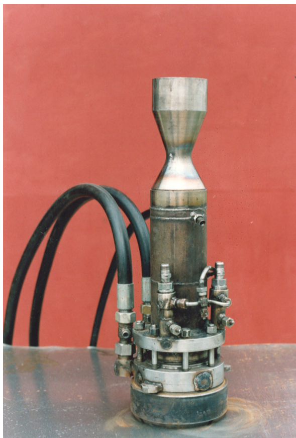
Фигура 13. Снимка на първия Индустриален Ракетен Двигател (ИРД) използван за задвижване на високоскоростен чук
