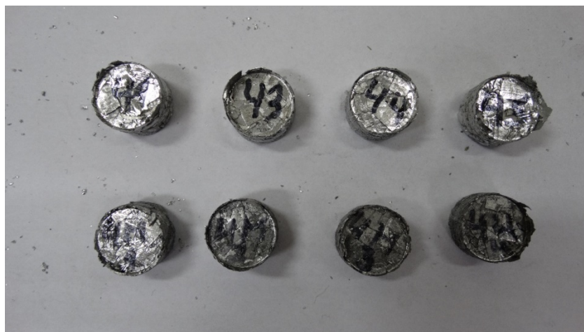
Фигура 72. а – брикети от алуминиеви стружки (А1 – А4 от почистени стружки; АМ1 – АМ4 от стружки във вид на доставка); б – брикети от чугуnenи стружки (Ч1 – Ч4 от почистени стружки; ЧМ1 – ЧМ4 от стружки във вид на доставка )
