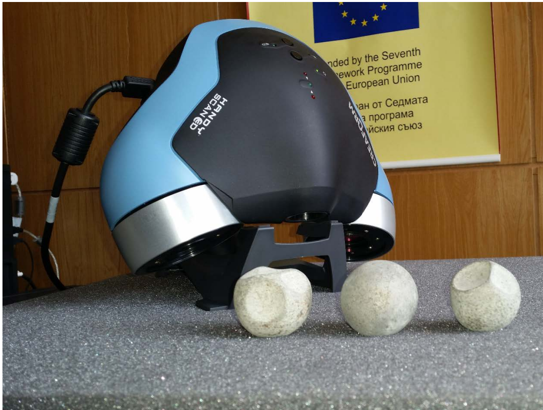
Фиг. 2.13. Мобилен 3D скенер
