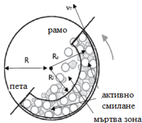
Фиг. 1.19. Движение на частиците от вътрешните слоеве на товара в мелница
