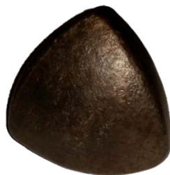
Фиг.1.23. Мелешо тяло с форма на сферичен тетраедър
