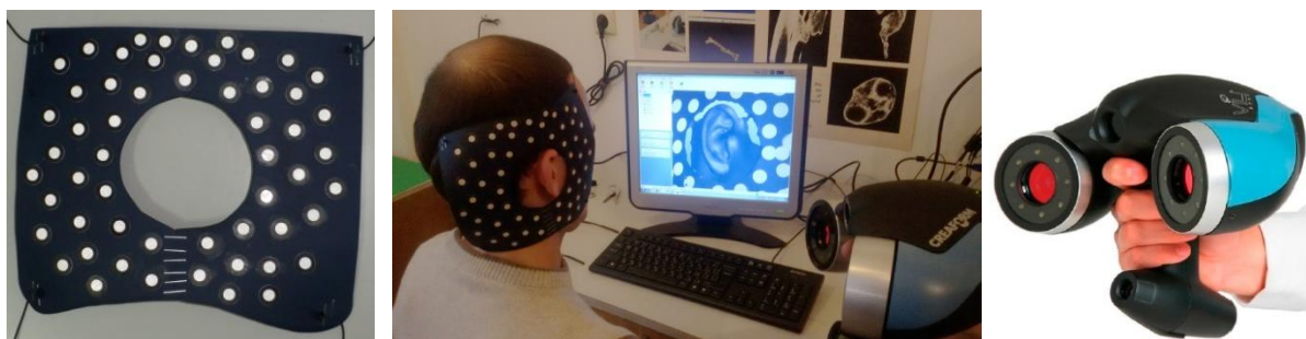
Фиг. 45. а) картонен „шлем“; б) сканиране на участник; в) 3D скенерът VIUscan.
