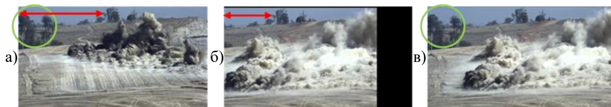
Фиг. 33. Стабилизация на видеоклип на контролиран взрив: а) първи кадър; б) последен кадър след стабилизация в точка (пъзене на сцената); в) последен кадър след стабилизацията по траектория (фонът е статичен).
