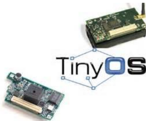
Фигура 5. Програмируеми сензори, поддържащи операционна система TinyOS
