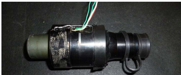
Фиг. 3.11. Външен вид на оптоелектронния канал на изследвания прототип
