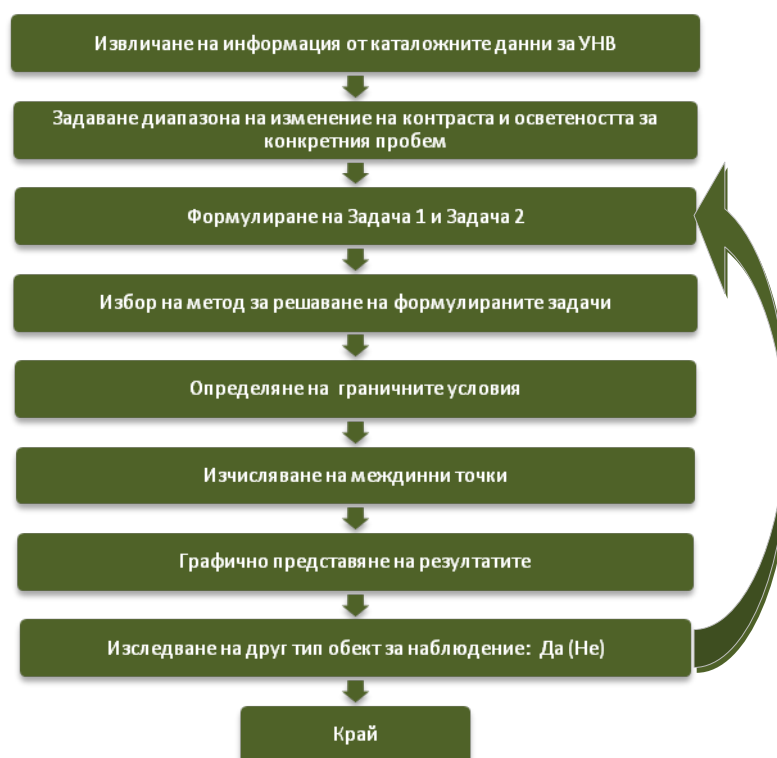
Фиг. 2.7. Методология за определяне на условията на наблюдение, при постоянно разстояние на действие
