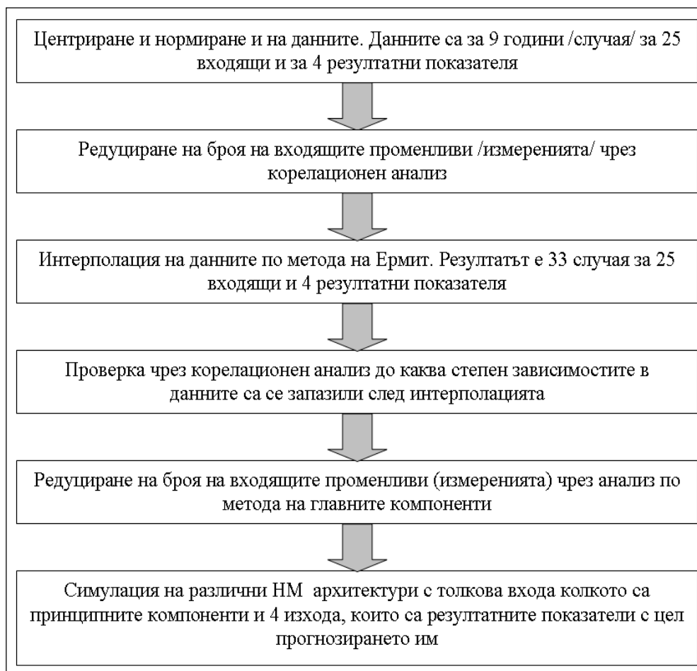
Фигура 3.1. Алгоритъм за изграждане на модел на структура на НМ
