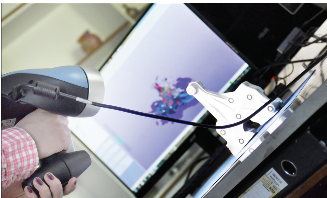
Учените използват лазерен скенер, за да създадат компютърен образ на обекта, който ще изследват. След това могат да отпечатат негова точна реплика на 3D принтер.
